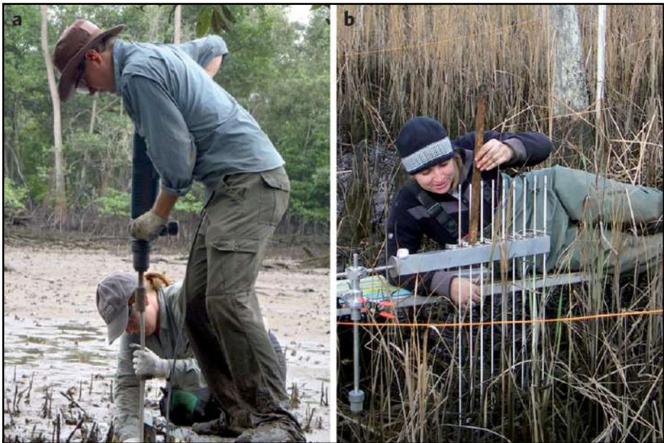
a) Instalação de uma haste RSET em um perfil de solo de manguezal (esquerda). b) Medição da elevação da superfície com o uso de RSET em uma marisma (direita).
