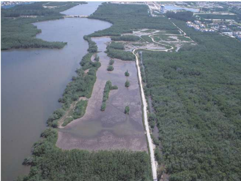
Figura 8.14. O projeto de criação de águas abertas para refúgio de peixes aumenta o habitat de pesca e pode acelerar a obtenção de um equivalente funcional de pesca e um habitat de forrageamento para aves marinhas, ambos objetivos comuns dos projetos de restauração de manguezais.
