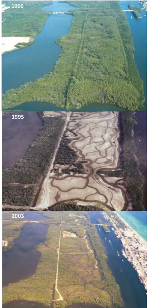
Figura 8.8. A antiga área de manguezal em West Lake, Flórida (EUA), estava coberta de pinheiros invasores Casuarina que cresciam sobre o material dragado das rotas de navegação adjacentes. Em 1995 foi realizada a REM que envolveu a escavação do material dragado e a criação de uma rede de canais de maré, tendo como base as características da floresta de referência próxima. Em 2003 já há um evidente fechamento completo do dossel, juntamente com um sistema funcional de canais de maré (todas as fotos de R. Lewis).
