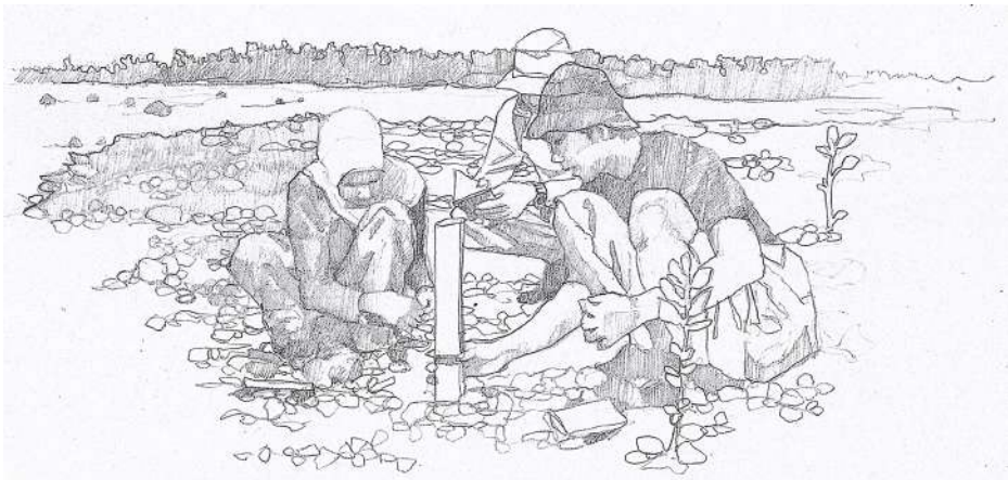
Figura 3.2. Demarcação do nível médio do mar, como parte de um treinamento REM.
